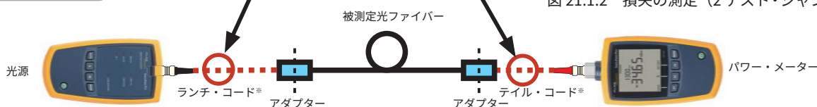
図 21.1.2 損失の測定 (2 テスト・ジャンパー法)
