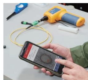
写真 25.1.2 一度に全ての芯線が確認できるタイプのスコープ
