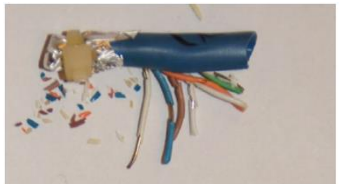
図 2: 120 °C で 10 日経過したケーブルの損傷と絶縁劣化
