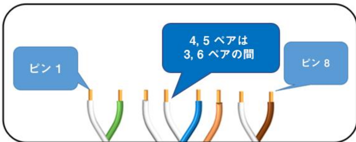
図 2: T568A の正しい終端処理
