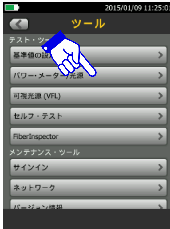
「パワーメーター / 光源」をタッチ
