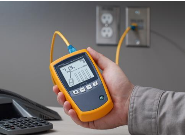
図 5. MicroScanner™ PoE は、スイッチによって報告されたクラスと電力レベルを表示します。
