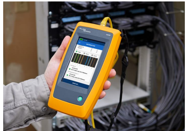
図 6. LinkIQ™ ケーブル+ネットワーク・テスター最大 10 Gb/s のケーブル性能を検証し、ネットワークの接続問題を解決するテスト・ソリューションです。
