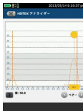
HTDTC (High Definition Time Domain Cross talk) が、遠端接続に問題があることを明確に表示
