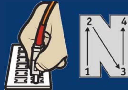
図 7： 「湿った場所から乾いている場所へ」：当社の 光クリーニング・カードを使用するクリーニング 手法。クリーニング材の「1」の部分に溶剤を 垂らし、端面をクリーニング材の「1」から「4」 へと動かします適切な溶剤を用いた湿式クリー ニングが必要な端面の代表的な例。
