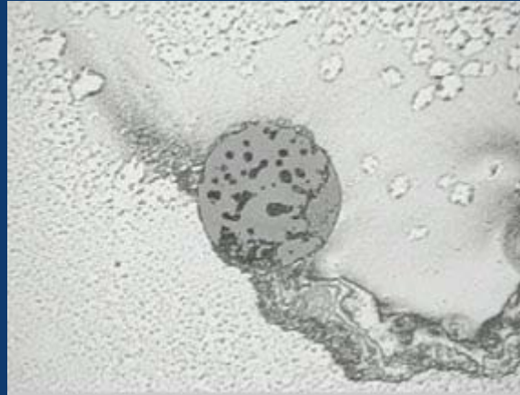
図 6： アルコールでクリーニングした場合の残留物。 適切な溶剤を用いた湿式クリーニングが必要な 端面の代表的な例。
