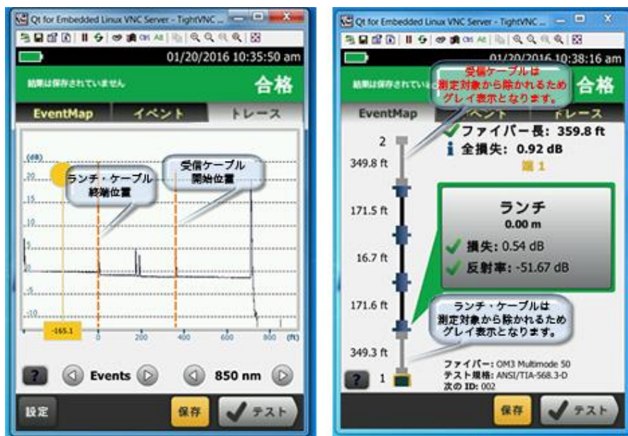
図 6. トレースには、テスト対象のリンクの始まりと終わりの部分のランチ・ファイバーおよび受信ファイバーが含まれます。右側に表示されている EventMap は、ランチ補正によってテスト結果からその影響を取り除いたものを示しています。
