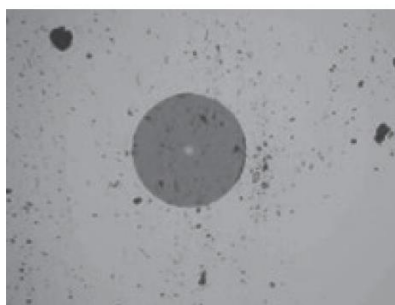
環境の悪いところで使用し、粉じん等で傷がついた例: クリーナーで拭いても改善しない。測定用には使えない。
