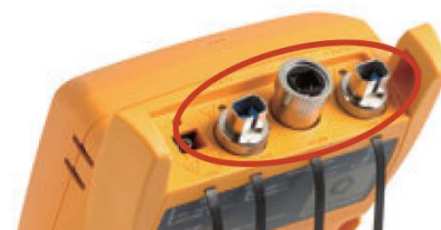
傷がついたコネクタを測定器に接続すると測定器側のフェルル端面に傷がつく場合があります、修理費用は高額となる。
