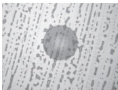
指の皮脂が付着した例: クリーナーで簡単に拭き取ることができ、問題無く測定に使用することができるが長期間汚れを放置すると固着する場合があります、その場合は測定コードの交換が必要。
