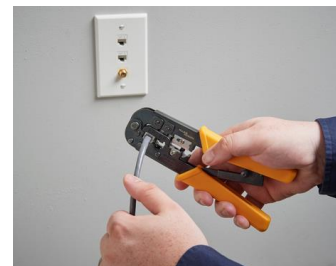
写真 4-3 圧着工具: フィールドで、ケーブルにモジュラープラグを取り付けるときに用います。
