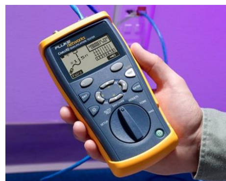
写真 6-4 Cable IQ 配線検証テスター
