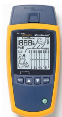
写真 5-2 MicroScanner 2 ケーブルビューアー
