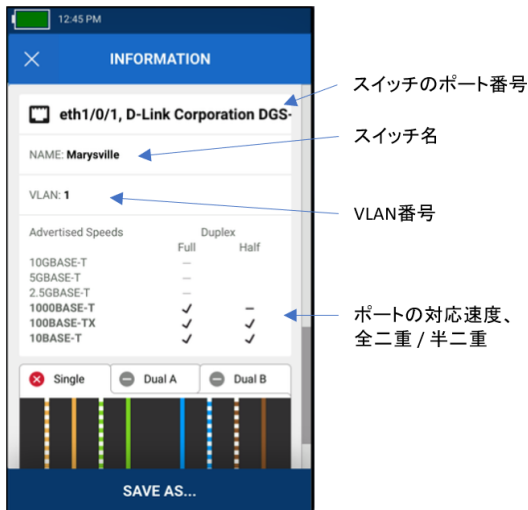
図 6-22 ネットワーク試験の不合格結果
