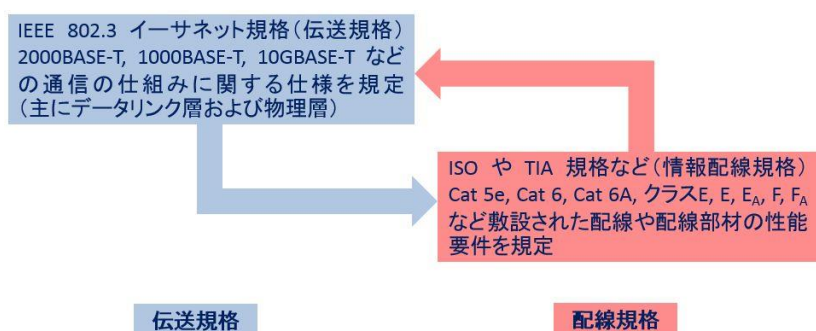
図 4-2 伝送規格と情報配線規格の関係
