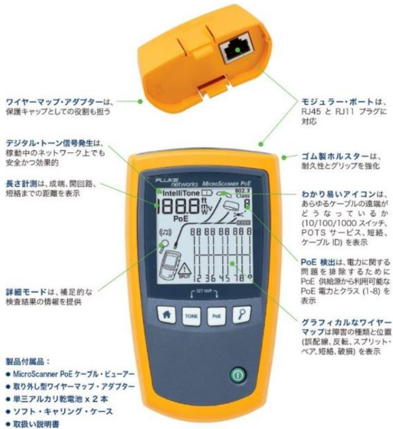
図 6-16 MicroScanner PoE ビューアーの多様な試験機能
